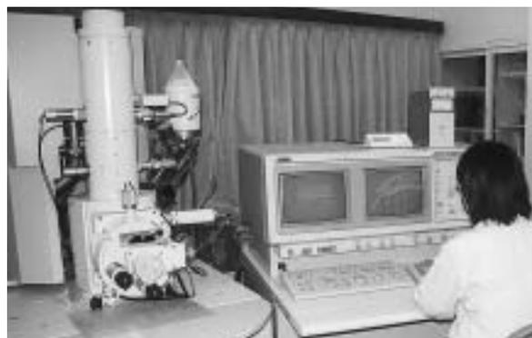
X線分析装置付走査型電子顕微鏡
